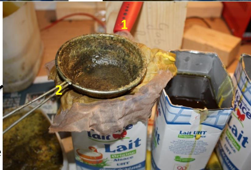
Passoire Filtration Grossière 2 positionnée dans la passoire avec le bas nylon Filtration Fine 1
