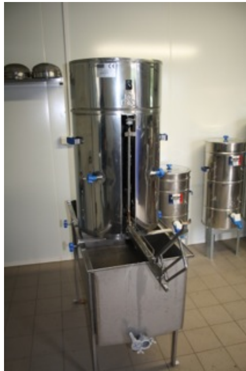
Désoperculation automatique des cadres
